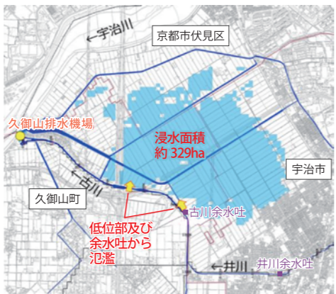
久御山排水機場が無かった場合の浸水被害 【出典】近畿地方整備局ホームページ
